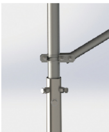
VGPCF13-B系列 立柱与斜撑、立柱与螺旋桩连接
